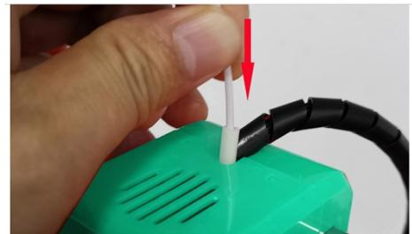
头会上升 1CM，所以机器上升的高度用户可以自己决定），按一下打印机面板上的 进料按键开关，当进料按键指示灯闪烁时，表示打印机的挤出头正在预热，**等待 2 分钟左右的时间**，打印机开始进料，当喷嘴挤出均匀的耗材细丝时表示进料成功，可以按一下 键结速进料。
