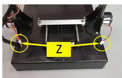
请检查X轴电机线连接器是否连接好
