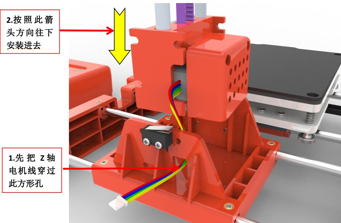
2. 按照下图所示打印喷头组件与打印底座锁螺丝固定。
