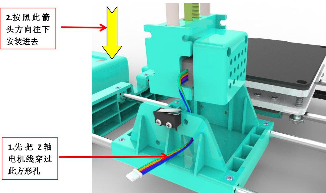
2. 按照下图所示打印喷头组件与打印底座锁螺丝固定。
