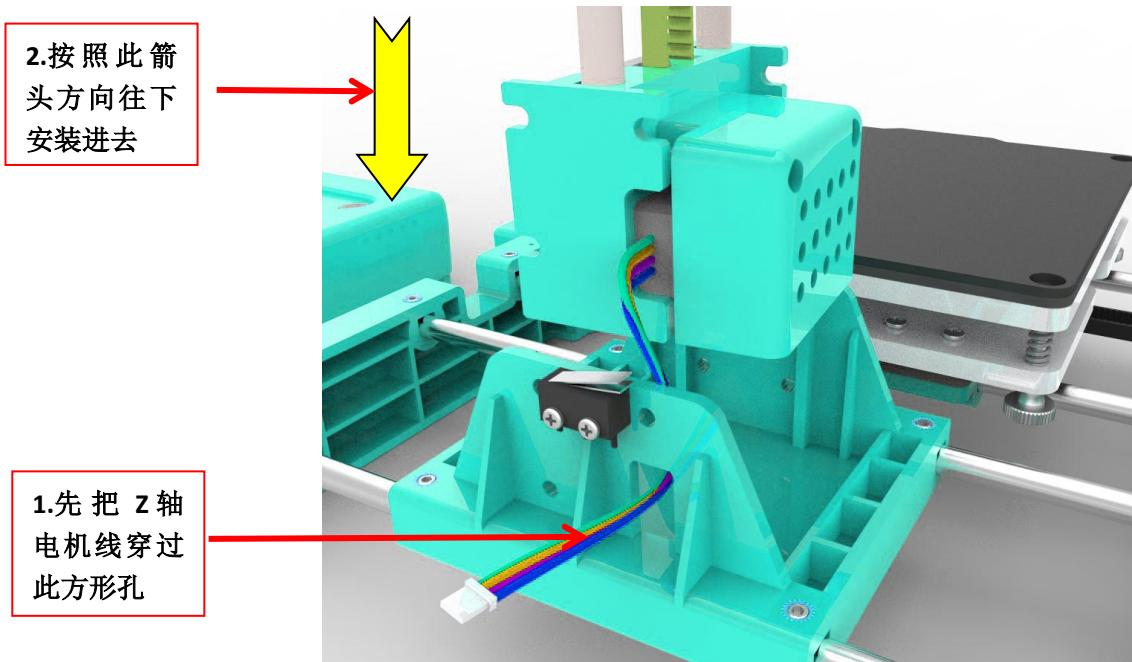
2.3,.按照下图所示打印喷头组件与打印底座用螺丝固定。
